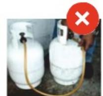
**No realice trasiego de gas de un cilindro a otro.**
